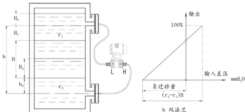
图5-9 用双法兰变送器测量分界面
