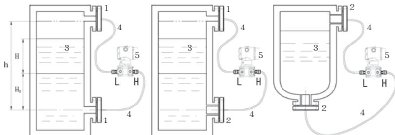
a、双平法兰      b、一平一插法兰      c、双插法兰
