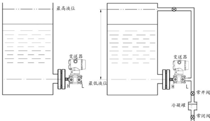
图5-3 不带迁移的液位测量
