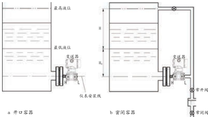
图5-5 用正迁移提高测量灵敏度
