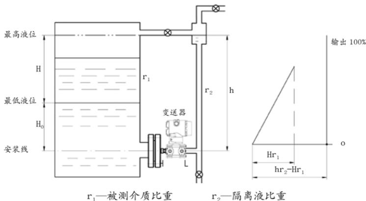
$h$ —隔离液高度       $H$ —液位变化范围       $H_0$ —不变液位高度
