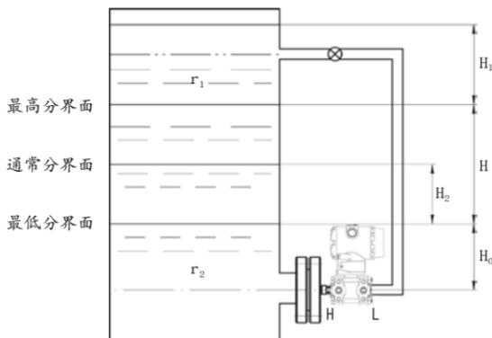
图5-6 用单平法兰液位变送器测量分界面
